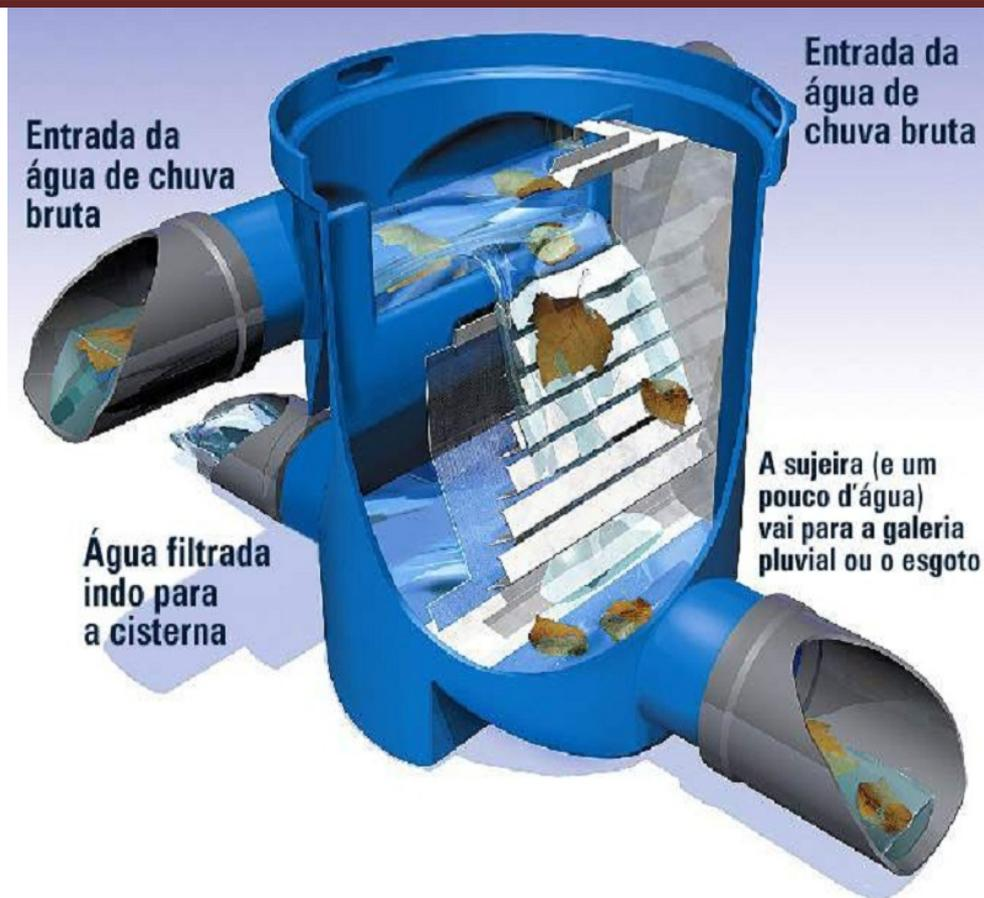
O sistema de captação consiste em recolher, filtrar, armazenar e disponibilizar esta água para uso em área externa ou interna, de acordo com as recomendações da Norma 15527 da ABTN – Associação Brasileira de Normas Técnicas.
