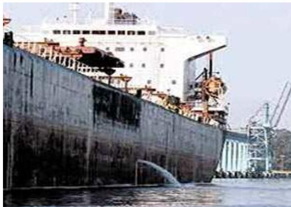
Figura 2 - Deslastreamento
