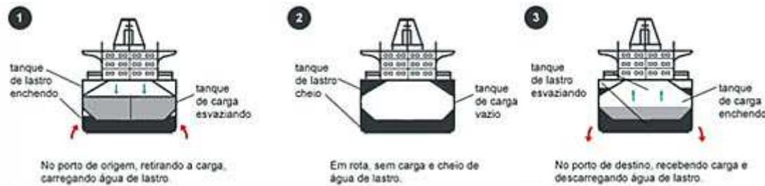
Figura 1 – Modelo de Lastreamento e Deslastreamento
